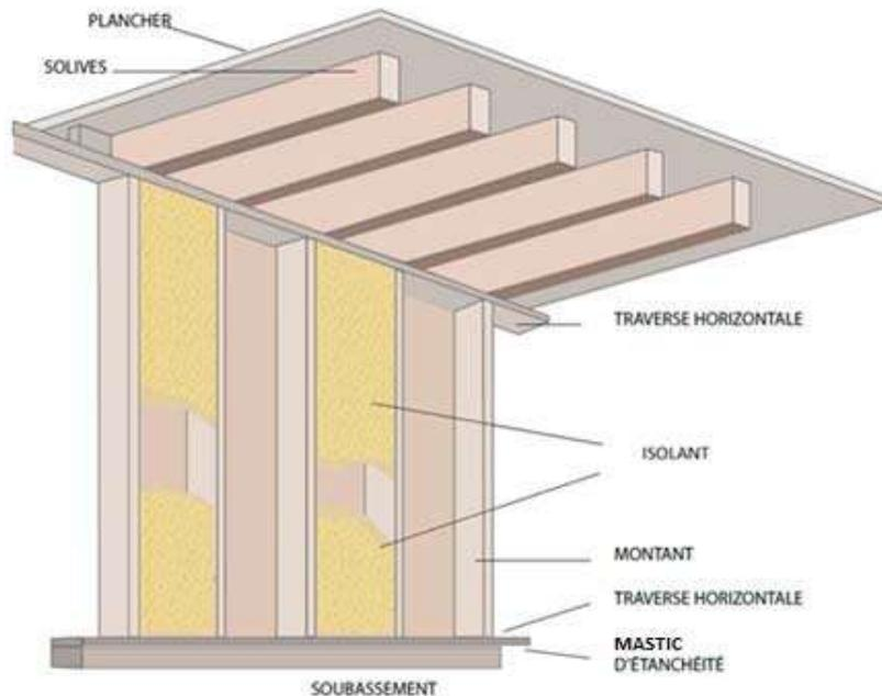
**Figure 9 : Raccord sol plafond**
