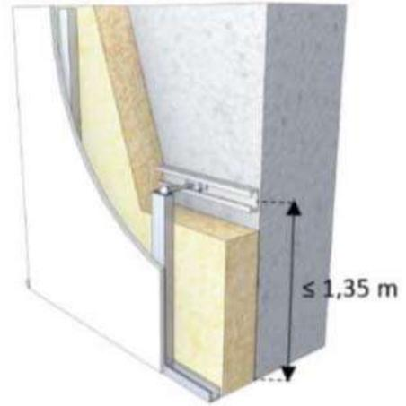
**Figure 14 : Détail au droit d'un appui intermédiaire**
