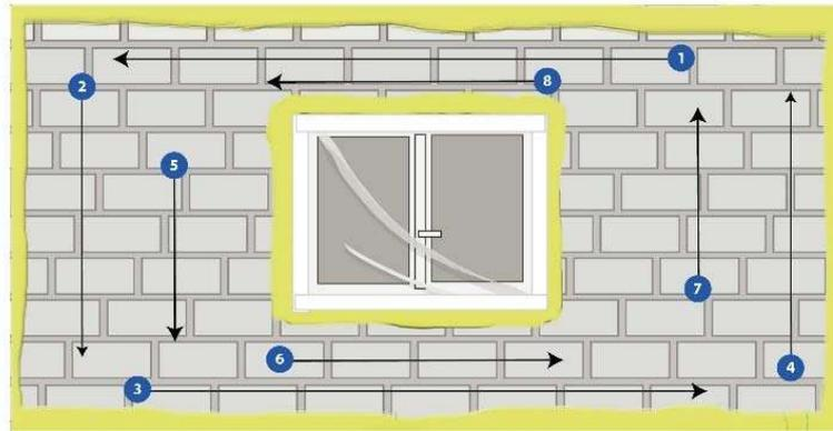
**Figure 3 : Isolation de la périphérie et des ouvertures**
