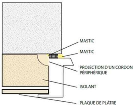
**Figure 5 : Ouverture calfeutrée en applique intérieure, fixée en applique intérieure avec espace technique (hors ERP)**
