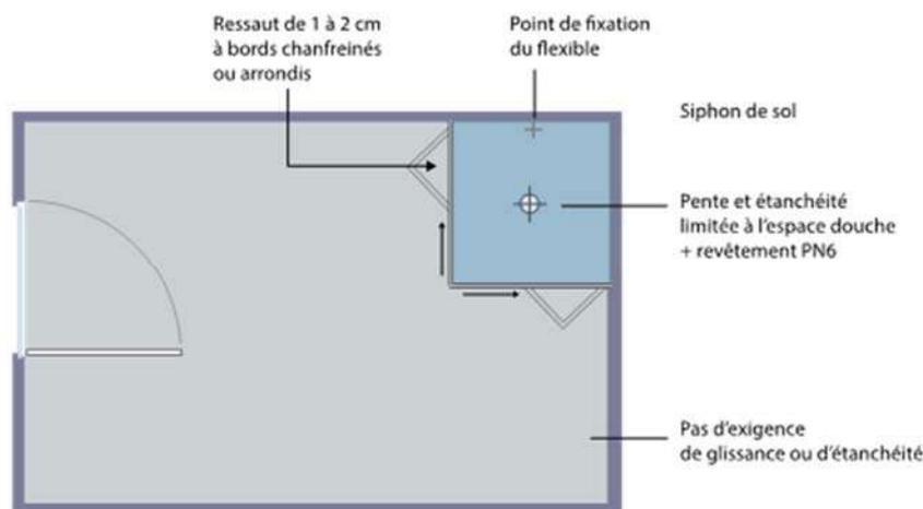
**Figure 7 : Cas où les projections d'eau sont partiellement contenues – semi-cloisonnement limité (Extrait du Guide pour la mise en œuvre d'une douche de plain-pied dans les salles d'eau à usage individuel en travaux neufs)**
