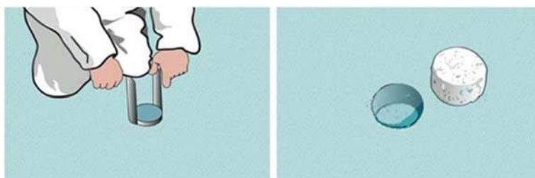
**Figure 1 : Prélèvement des éprouvettes par carottage**
