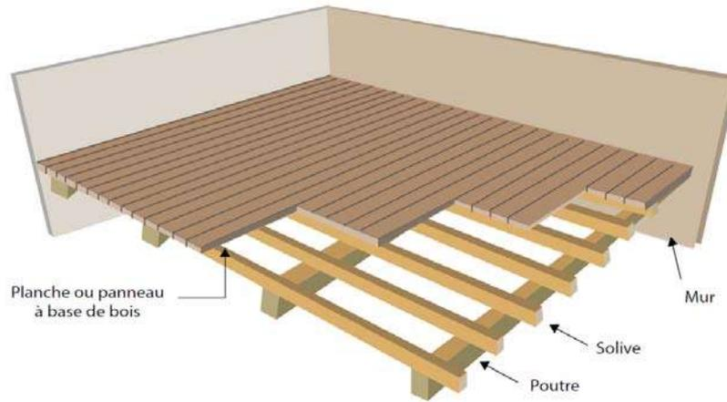
**Figure 2 : Plancher bois avant projection de l'isolant**
