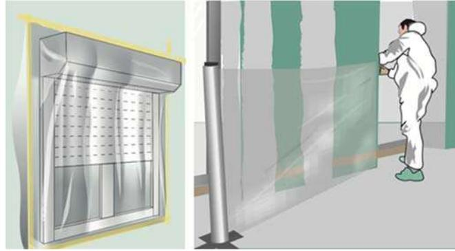
**Figure 3 : Protection des éléments de construction**
