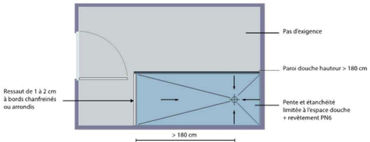
**Figure 6 : Cas où les projections d'eau sont contenues et la surface délimitée par un ressaut de 1 à 2 cm (Extrait du Guide pour la mise en œuvre d'une douche de plain-pied dans les salles d'eau à usage individuel en travaux neufs)**
