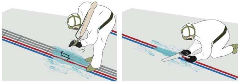
**Figure 10 : Enrobage des gaines et arasement de l'excédent**
